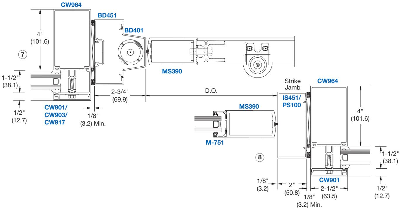
TYPICAL EXPOSED HINGE TUBE JAMB
