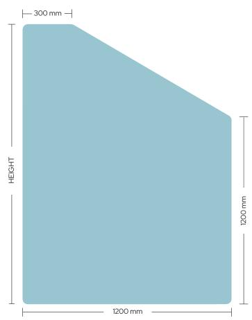
RETAINING WALL TOUGHENED POOL GLASS PANEL
